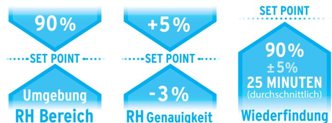
**RH** Bereich: Umgebung bis 90% Genauigkeit: +5%/-3% Wiederfindung: 5% innerhalb 25 Minuten
