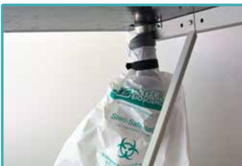
Durchlass unter die Arbeitsfläche in einen Müllsack
