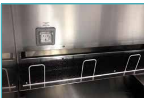
Grobfilter in der Rückwand zum Schutz des Hauptfilters
