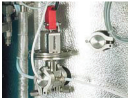
FVG - Membrane safety device for preventing lid opening even in case of minimal over pressure FVG - Membran-Sicherheitsvorrichtung verhindert Deckelöffnung bereits bei geringstem Überdruck
